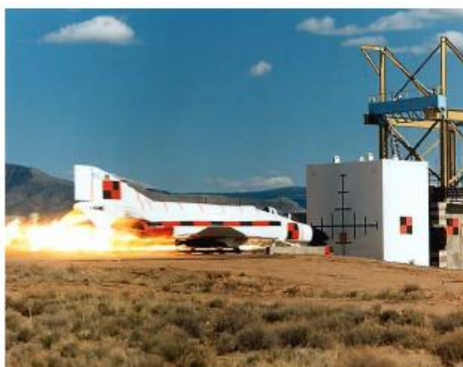
شکل (۲-۱) تست برخورد هواپیما به بلوک بتنی در اندازه واقعی [۸].
